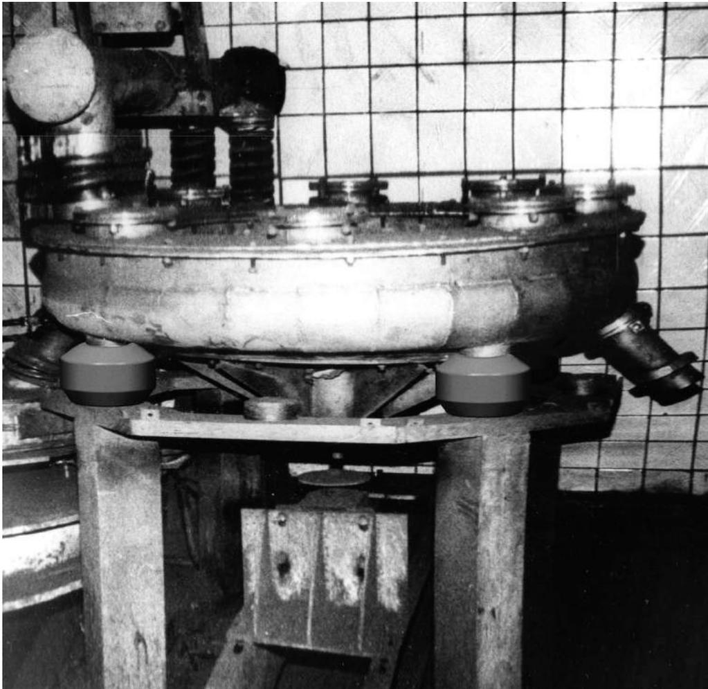
Рис. 6.4.3 – Узел смешения и гранулирования (виброизоляторы типа ВР)
