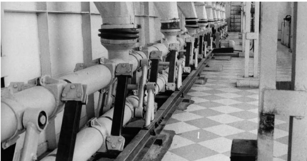
Рис. 6.3.3 – Вибрационные конвейеры KB2T-15 в цехе
