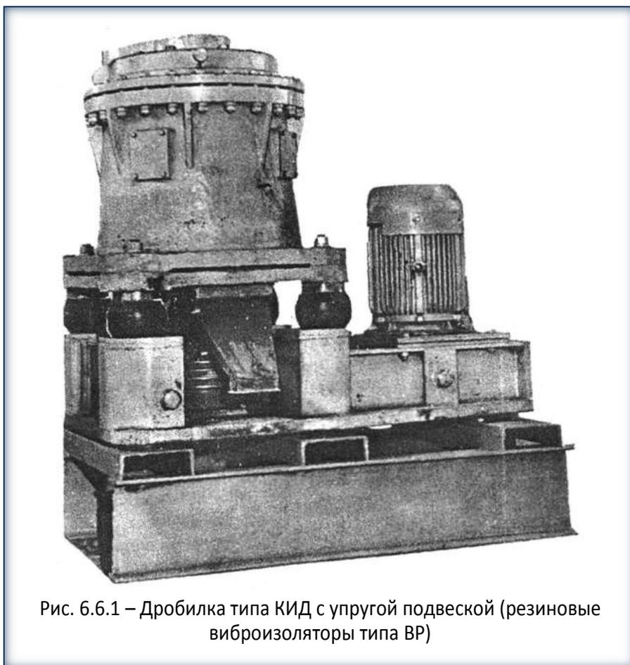
Рис. 6.6.1 – Дробилка типа КИД с упругой подвеской (резиновые виброизоляторы типа ВР)
