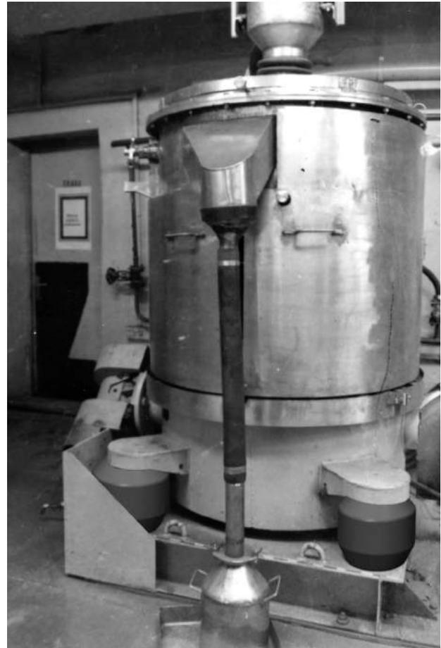
Рис. 6.5.2 – Сушилка вибрационная СВП-02 с виброизоляторами типа ВР
