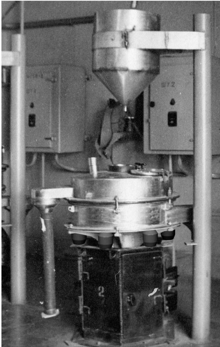
Рис. 6.4.5 – Вибрационное сито СВ-06 (виброизоляторы типа ВР)
