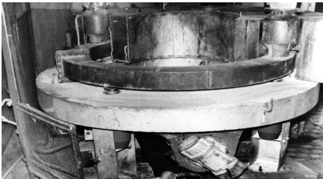
Рис. 6.5.3 – Вибрационная печь ВП-0,07-567 с виброизоляторами ВР
