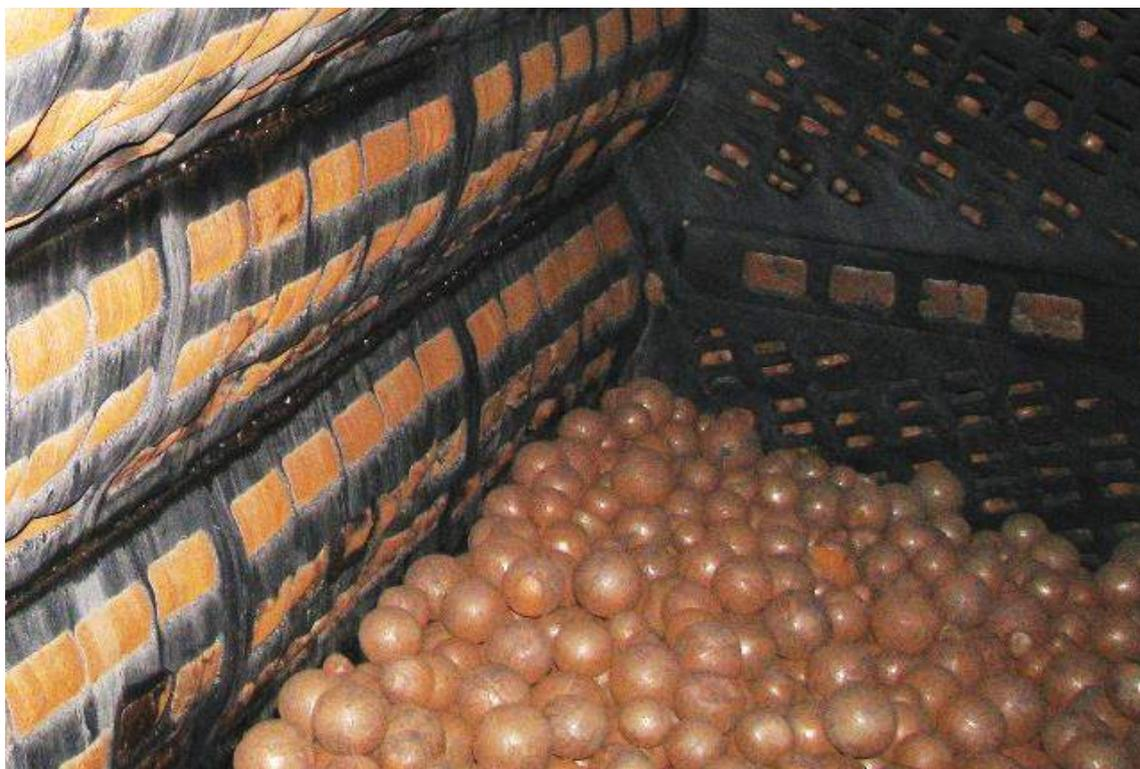
Рис. 6.5 – Резиновая футеровка «Г.М-волна»; СевГЭК, мельница  $\varnothing 3,6$  м, первая стадия измельчения, шары  $\varnothing 100$  мм,  $t = 6,5$  мес.
