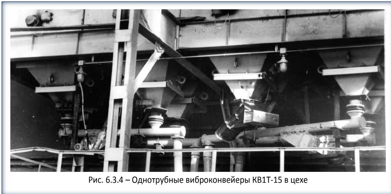
Рис. 6.3.4 – Однотрубные виброконвейеры KV1T-15 в цехе
